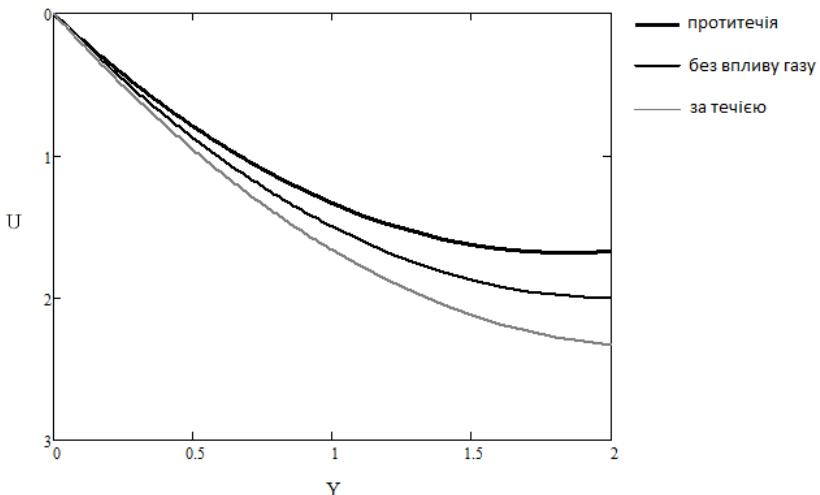
Рис. 2. Профілі поздовжньої швидкості в рідких плівках
